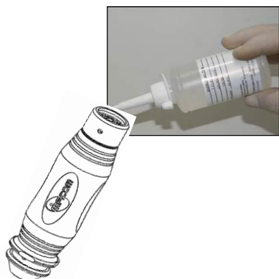
Lubrificação do motor do Trépano
