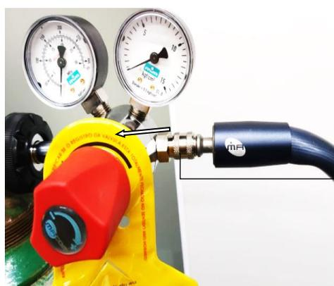
Obs.: Para soltar a mangueira da válvula reguladora, deve-se tracionar o engate para trás, conforme figura 6.
